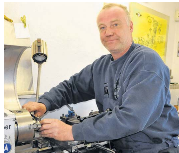
Bei Bedarf kann der Kfz-Technik-Meister Peter Malchow Ersatzteile selbst herstellen, unter anderem auf der Drehbank. Ganz wichtig, wenn es um Teile für ältere Fahrzeuge geht.
